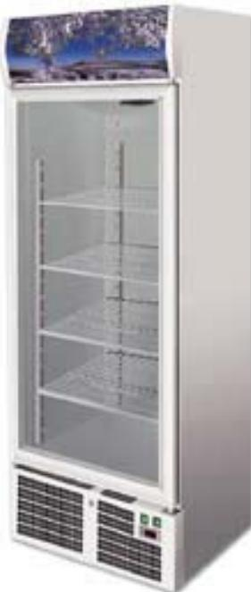
Armadio refrigerato. Struttura esterna in lamiera verniciata epossidica bianca, interno in alluminio verniciato epossidica bianco. Gas R134A 230V 50 HZ. Assorbimento elettrico W456. Sbrinamento ed evaporazione automatico. Refrigerazione statica con ventola. N.4 griglie plastificate. Chiusura porta con molla di ritorno. Luce interna. Isolamento 50 mm. Pannelli esterni di fondo e retro in lamiera zincata. Max temperatura ambiente 33°C.
