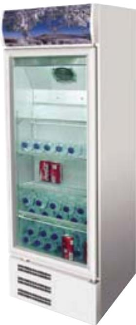
Armadio refrigerato. Struttura esterna in lamiera verniciata epossidica bianca, interno in alluminio verniciato epossidica bianco. Gas R134A 230V 50 HZ. Assorbimento elettrico W340. Sbrinamento ed evap- razione automatico. Refrigerazione statica con ventola. N.4 griglie plastificate. Chiusura porta con molla di ritorno. Luce interna. Isola- mento 50 mm. Pannelli esterni di fondo e retro in lamiera zincata. Max temperatura ambiente 33°C.
