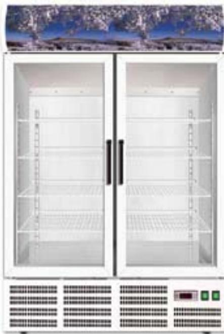
Armadio refrigerato. Struttura esterna in lamiera verniciata epossidica bianca, interno in alluminio verniciato epossidica bianco. Gas R134A 230V 50 HZ. Assorbimento elettrico W650. Sbrinamento ed evaporazione automatico. Refrigerazione statica con ventola. N.8 griglie plastificate. Chiusura porta con molla di ritorno. Luce interna. Isolamento 50 mm. Pannelli esterni di fondo e retro in lamiera zincata. Max temperatura ambiente 33°C.
